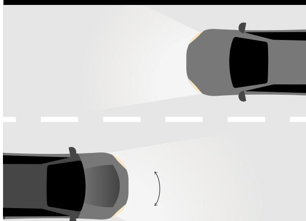
Sistema Control inteligente de luces de carretera (detecta el tráfico en sentido contrario y **adapta las luces para evitar deslumbramientos**), o el Sistema de reconocimiento de señales de tráfico (detecta y muestra información de utilidad sobre las mismas).
