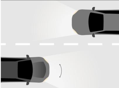
Sistema Control inteligente de luces de carretera (detecta el tráfico en sentido contrario y **adapta las luces para evitar deslumbramientos**), o el Sistema de reconocimiento de señales de tráfico (detecta y muestra información de utilidad sobre las mismas).
