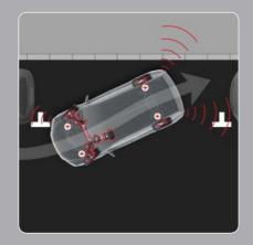
SENSOR DE PARKING DELANTERO Y TRASERO CON SISTEMA AVANZADO DE ASISTENCIA DE APARCAMIENTO (IPA)
