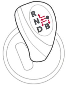
**D** de Drive: posición en la que debe estar situada la palanca para conducir. Para circular, retirar con suavidad el pie del freno.
